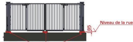
Après l'installation, remplissez l'espace entre le bloc de fondation et la plaque de base de la colonne colonne jusqu'à 1 cm sous la plaque de base.
